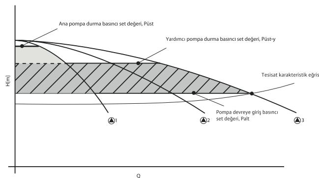
Tesisatta ihtiyaç duyulan debiye göre, set edilen basınç değerleri aralığında pompalar sıra ile devreye girer. Sistemin çalışma aralığı, tüm pompalar için geçerli olan Palt basınç değeri ile yardımcı pompalar için Püst-y ve ana pompa için Püst değeri arasındadır. Sistem basınç Püst değerine ulaştıktan sonra set edilen gecikme süresi kadar sonra pompa durur. Bu gecikme sayesinde basınç darbeleri ve küçük debi talepleri nedeniyle sistemin çok sık devreye girip çıkışması önlenmiş olur.
