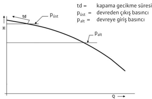
Tesisatta ihtiyaç duyulan debiyi sağlamak için, pompa set edilen alt ve üst basınç değerleri arasında çalışır.
